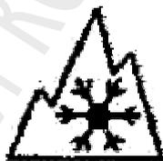
Рисунок 5.1. Маркировка, наносимая на зимнюю шину
